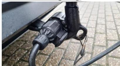
Nachdem, die elektrische Verbindung zwischen Zugfahrzeug und Anhänger mittels Stecker hergestellt worden ist, funktioniert die hintere Beleuchtung des Anhängers analog zu der des Zugfahrzeugs. Bei größeren Anhängern gibt es darüber hinaus Umrissleuchten, Begrenzungsleuchten und Seitenmarkierungsleuchten.
