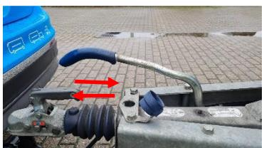
Für diese Variante braucht man eine zweite Person. Diese beobachtet bei der Bremsung die Gummimanschette der Deichsel und zwar beim Anfahren und bei der Bremsung. Die genau wie bei Variante 2 mit ca. 10km/h ausgeführt wird. Die Manschette muss bei der Bremsung „eintauchen“ und sich bei wieder anfahren auseinanderziehen. Taucht die Manschette ein und gibt es dabei kein lautes metallisches Geräusch, ist die Bremse in Ordnung.
