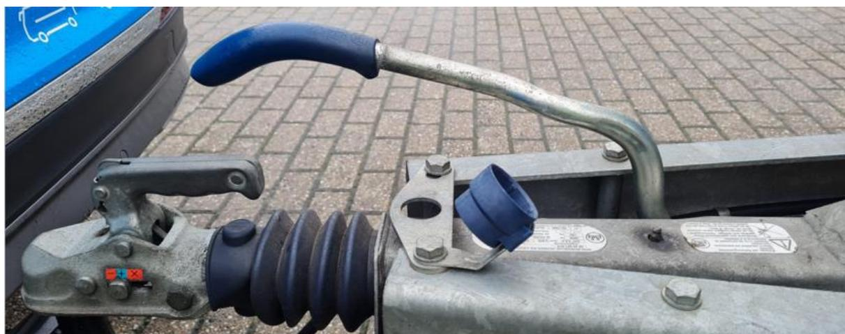
Die Bremse am Anhänger ist eine Auflaufbremse. Bremst das Zugfahrzeug drückt der Anhänger gegen das Zugfahrzeug. Die im Bild abgebildete Gummimanschette beinhaltet die Zugstange die starr mit der Kugelkopfkupplung verbunden ist. Der Anhänger rollt beim bremsen weiter Richtung Fahrzeug. Die Zugstange betätigt in dem Fall eine Umlenkung die das Bremsgestänge anzieht und die Bremse betätigt.
