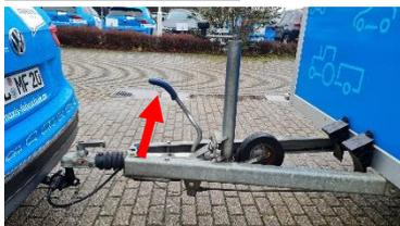
Man fährt vorsichtig und langsam mit angezogener Feststellbremse los. Das Zugfahrzeug geht hinten runter. Da sich der Anhänger nicht richtig ziehen lässt. Ein Beweis das die Bremse funktionsbereit ist.
