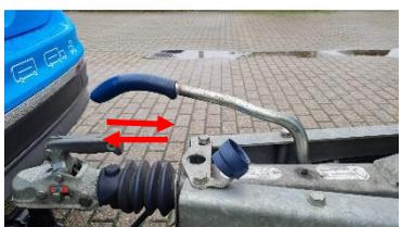
Man fährt (jetzt mit gelöster Feststellbremse) vorsichtig los. Mit ca. 10km/h und macht dann eine stärkere Bremsung bis zum Stillstand. Dabei beobachtet man im Rückspiegel den Anhänger. Läuft dieser auf und macht es dabei kein lautes metallisches Geräusch ist die Bremse in Ordnung.
