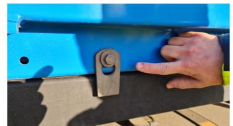
Sicherung der Stützbeine
